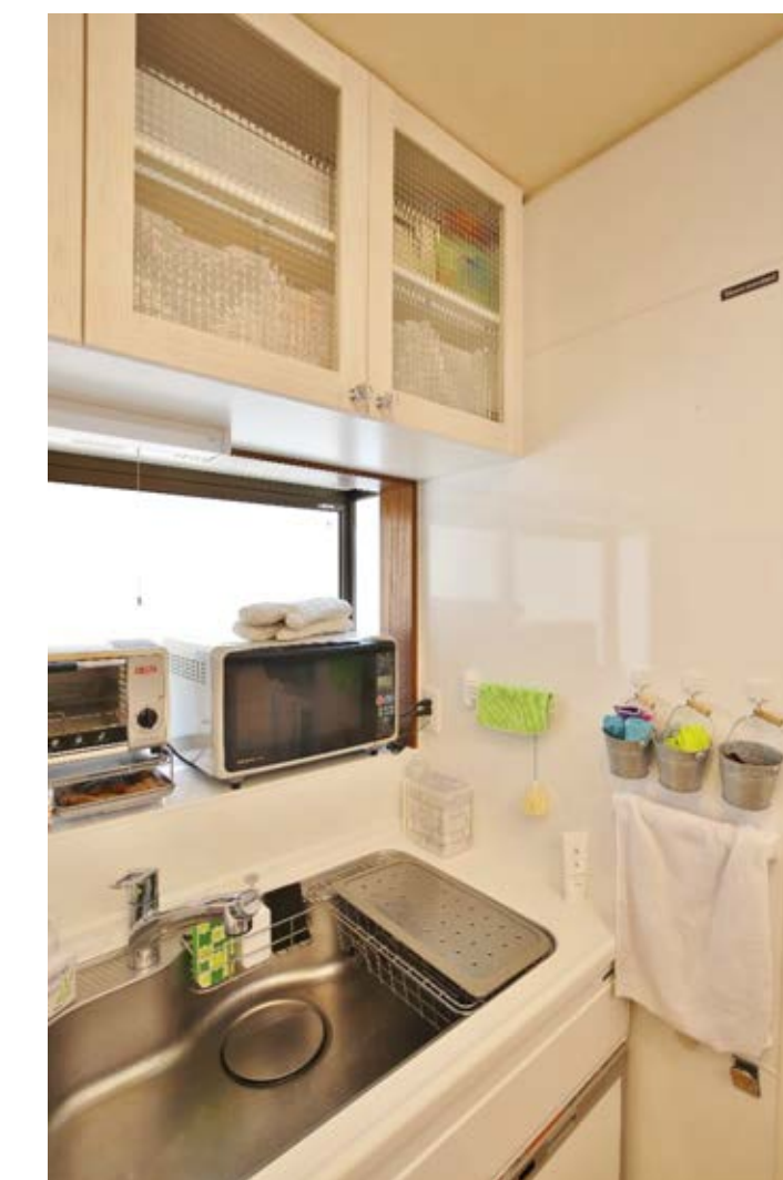
シンクの側面にホーロー素材のパネルを設置。マグネットの付いた小物入れなどで自分好みにカスタマイズできる
