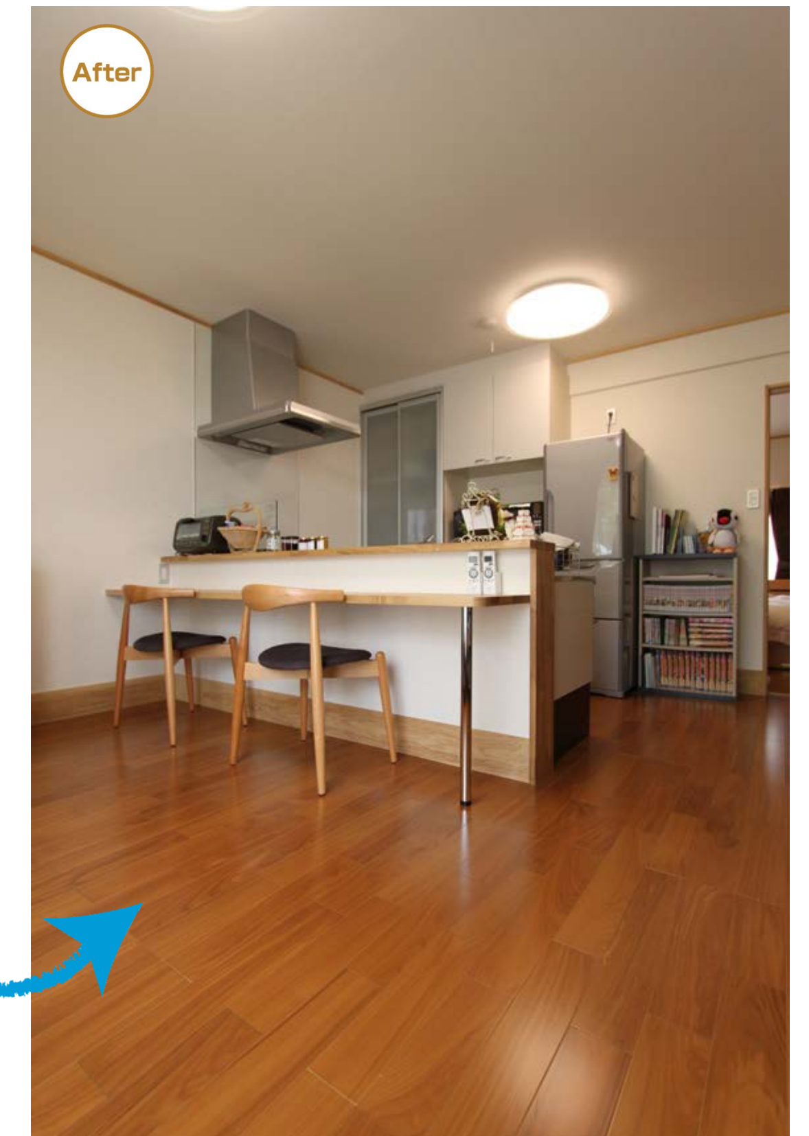
床での生活が多い奥さまのために、床暖房も設置。巾木も車いすでの移動で傷がつきにくいように幅を広くしています。
